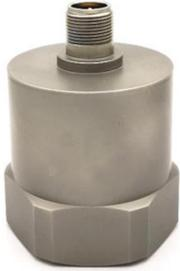
G30AS系列加速度传感器是一款专门为大型建筑、基础设施和地震探测等应用设计的用于探测超低频和低频振动的加速度传感器；其特点是通过传感机构输出一个低噪声并且高幅值的信号，具有出色的测量分辨率。陶瓷晶体和石英晶体都可用于地震加速度传感器的设计，陶瓷晶体具有比石英晶体更高的输出效率。G30AS产品采用陶瓷晶体作为敏感元件，因此具有更好的信号品质和低频响应特性，内置低噪声信号调制器，因此具有很高的分辨率。为了达最好的测量效果，地震加速度传感器通常搭配增益放大器和电源信号调制器一起使用。此加速度传感器采用激光焊接的方式将不锈钢外壳与军用型接头牢固焊接在一起；外壳隔离，内部屏蔽，外部环境（包括RF、EMI、ESD以及过载）和误操作对产品的影响完全可控，从而保证了产品卓越的重复性和长期稳定性
