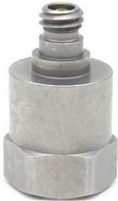
G50AS系列是一款可同时测量振动和冲击的IEPE单轴加速度传感器，其特点是采用环形剪切模式的陶瓷晶体为敏感元件，具有长时间保持输出稳定的特性。此加速度传感器的内部电路（可选TEDS功能）是在IEPE系统的两线制上同时提供恒流源激励和传输低阻抗电压输出信号，信号地与外壳相连，绝缘安装螺丝及安装座可选；同时信号放大电路设计考虑了极性反向保护。外壳采用激光焊接工艺以保证产品的密封性；输出连接头采用微型10-32的玻璃绝缘连接器以满足不同环境下使用时输出的稳定性。G50AS系列加速度传感器除了粘合剂安装还提供了10-32的螺纹孔以便牢固安装；G50AS系列加速度传感器具有宽频带响应特性，广泛应用于轻量结构产品做振动、冲击测试；同时也应用于包装行业的跌落测试设备。另外，还提供与微型10-32接头配套的线缆，型号1032可选，具体参见配件表格。
