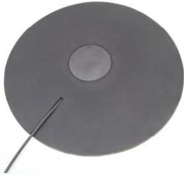
G71AT系列产品是一款专用于测量人体振动感的IEPE三轴座垫加速度传感器，该型号满足ISO 2631-1和ISO 8041标准要求。此产品的内部是一个可替换的，输出信号为 $\pm 5000\text{mV}$ 的三轴加速度传感器，专为中高低频测量设计的，测量分辨率可达 $1\text{mg}$ 。G71AT产品输出采用导线转BNC\*3的简易接口方式，采用剪切模式工作的压电陶瓷为敏感元件，具有宽频带响应特性。同时适用于低频测量，信号通过线缆输出。此款加速度传感器允许测试工程师在车辆或测试平台上同时测量三个轴向的振动加速度，具有良好的可靠性和长期稳定性。此IEPE加速度传感器结合优质的晶体和专业的电子线路设计，与其他敏感元件设计相比，该产品具有在整个操作温度范围内非常低的温度灵敏度响应特性。G71AT加速度传感器使得测试工程师可以很方便的同步测量三个相互垂直轴向的加速度，测试数据可靠，长期稳定。
