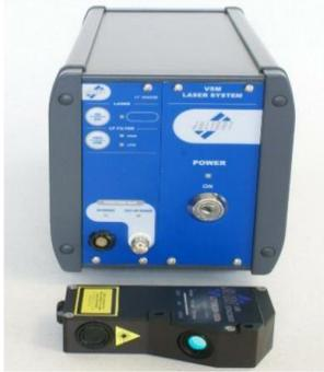
激光发射器通过镜头将可见红色激光射向被测物体表面，经物体反射的激光通过镜头，被内部的位置探测器（PSD）接收，根据不同的距离，PSD可以在不同的角度下“看见”这个光点。根据这个角度及已知的激光和PSD之间的距离，数字信号处理器就能计算出传感和被测物体之间的距离。
