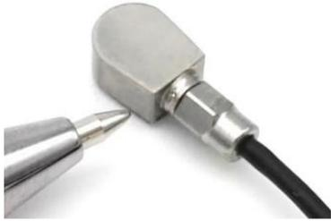
M71AS系列产品是一款微型IEPE单轴加速度传感器，防护等级可以达到IP68，适合在潮湿、油污等环境下进行振动和冲击测试，其特点是采用环形剪切模式工作的压电陶瓷晶体结构，具有输出长期保持稳定的特性。M71AS加速度传感器内部电路是一个2线制IEPE电路系统，既可以提供恒流激励同时传输低阻抗的电压信号；信号地与外壳相连，标配绝缘垫片，绝缘安装座可选搭配使用；同时信号放大电路设计考虑了极性反向保护。产品采用钛合金激光焊接结构，保证了产品的轻质量和密封性；玻璃密封连接器保证了产品的长期稳定性，特殊防水连接技术保证了产品的密封性和方便性。M71AS产品具有宽频带响应特性，所以广泛应用于轻量结构产品做振动、冲击测试；特别适合于轻型结构的水力学测试项目。M71AS集成了定制长度电缆和1032的输出连接器。
