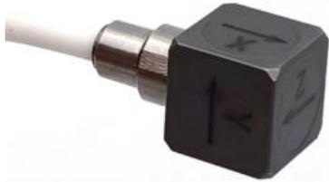
M75AT系列产品是一款为长期水下应用设计的IEPE三轴加速度传感器，采用剪切模式运行的压电陶瓷作为敏感元件，具有宽频带响应特性。此IEPE加速度传感器通过结合优质的晶体和低噪声微电子元件产生信号，与其他敏感元件相比在工作温度范围内获得了超低温度灵敏度变化/响应；剪切模式技术同时保证了卓越的基座灵敏度应变误差。M75AT系列产品采用激光焊接钛合金金属外壳，并将线缆集成一体输出使得产品适合在水下的使用。出色的振幅和相位频率响应，使得此产品非常适合结构验证、零件测试、跌落试验和实验室水力学测试。微型立方体结构使得测试工程师或技术员可以很方便的同步测量三个相互垂直轴向的加速度，测试数据可靠，长期稳定。
