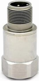
Y32AS系列产品是一款振动测量用IEPE加速度传感器，特点是采用环形剪切模式的陶瓷晶体为敏感元件，具有长期保持输出稳定的特性。此加速度传感器的内部电路是在 IEPE 系统的两线制上同时提供恒流源激励和传输低阻抗电压输出信号，信号地内部屏蔽，并与外壳隔离；同时信号放大电路设计考虑了极性反向保护。外壳采用激光焊接工艺以保证产品的密封性；输出连接头采用标准的 MIL-C-5015 玻璃绝缘连接器以满足不同环境下使用时输出的稳定性；Y32AS系列加速度传感器支持粘合剂安装，也支持 1/4-28 的螺纹孔牢固安装。Y32AS系列加速度传感器具有频带响应宽和抗冲击的特性，所以常在有意外冲击信号的环境下用于工业振动监控。另外，森瑟科技还提供与标准 MIL-C-5015 接头配套的线缆，具体参见配件表格。
